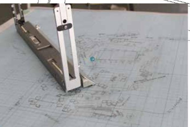
◆角度、距離を測定しながら図面に落とし込んだ。①部屋全体②各テーブル上の資料別と、マクロとミクロの記録を取った。手書きの図面は上図のようにデータ化した。(2015年6月24日製図)
