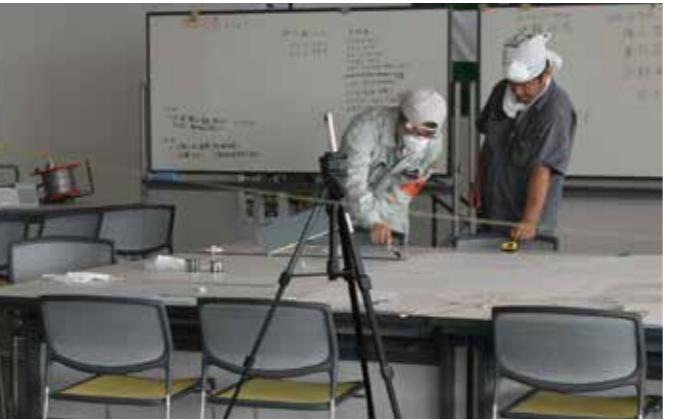
◆空間の記録に使用した360度カメラ。三脚に設置し、スマートフォンやタブレット端末のアプリを通じて撮影した。(2015年6月24日撮影)
