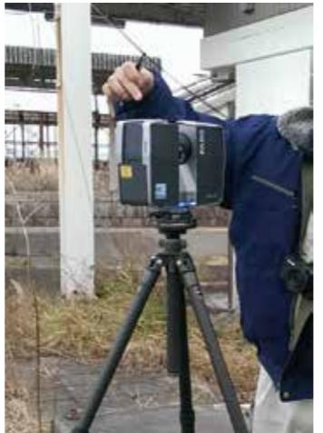
土木工事などの現場で利用されている三次元測量技術を使い、空間としての記録保存を試みた。記録したデータはノイズなどを除去した上でMRシステムという機材により再生する方法を採用した。
